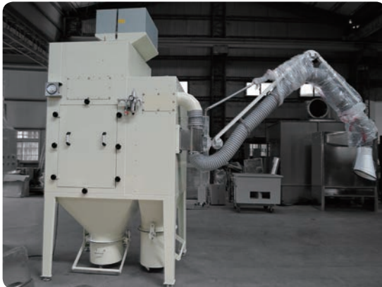
複合式集塵+可調式吸塵手臂 滑軌-螺桿製造廠, 精密機械廠
